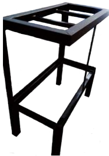
Estación de baterías para montacargas
